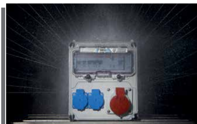
Testování odolnosti proti stříkající vodě
