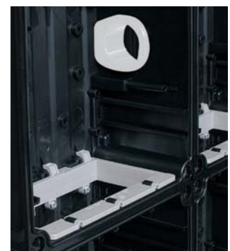
Modulární připojovací systém VARIABOX umožňuje díky vnitřním průchodům (horizontální průchodka M50 a vertikální obdélníkový otvor 160x70mm) snadné propojení jednotlivých modulů.
